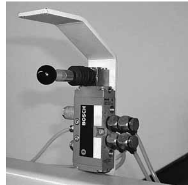
Bild 1: Pneumatischer Tippschalter. Der Druckbalken senkt sich, während der Schalthebel gegen unten gedrückt wird. Beim Loslassen wird die Senkbewegung unterbrochen.
