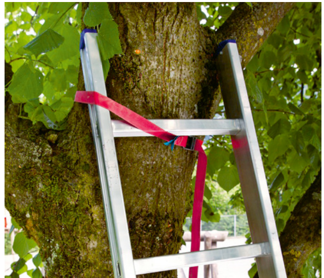
44 Sécurisation au moyen de sangles d'arrimage
