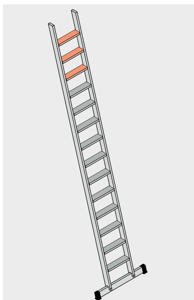
31 Échelle simple: ne pas monter sur les trois dernières marches.
