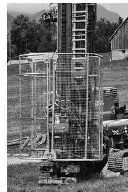
Bild 4: Bohrgeräte, die nach dem 10.3.2015 in Verkehr gebracht wurden, müssen mit einer trennenden Schutzeinrichtung oder gleichwertig ausgerüstet sein.
