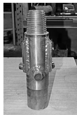
Bild 6 und 7: Die Bohrgestänge-Adapter müssen an die Arbeiten angepasst sein. Die Mitnehmer-Nocken müssen immer geschützt sein. Nach Bedarf sind diese Adapter bei nicht verrohrter Bohrung zu entfernen (DIN EN 791).
