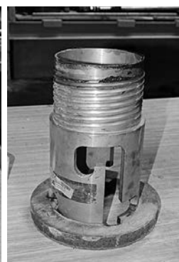
Bild 6 und 7: Die Bohrgestänge-Adapter müssen an die Arbeiten angepasst sein. Die Mitnehmer-Nocken müssen immer geschützt sein. Nach Bedarf sind diese Adapter bei nicht verrohrter Bohrung zu entfernen (DIN EN 791).
