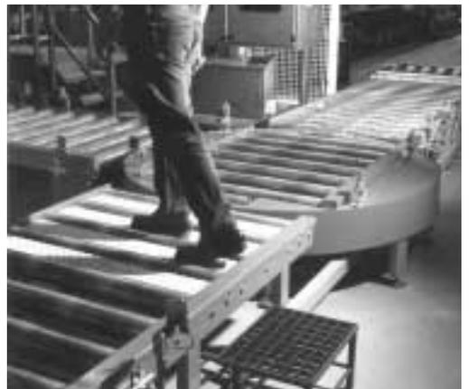
Bild 8: Laufsteg über eine Rollenförderanlage.
