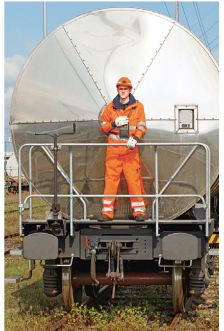
6 Fahrwegüberwachung von der Zugspitze aus auf sicherem Podest.
