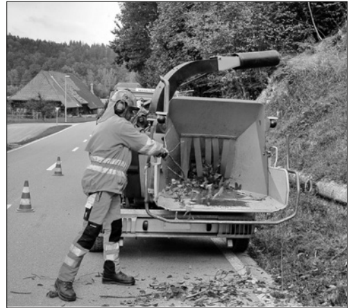
1 La commande qui se trouve sur le côté et le dessous de la déchiqueteuse permet aussi d'arrêter la machine. Il y a également deux boutons d'arrêt d'urgence.
