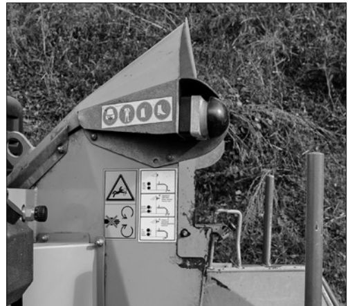
2 Les fonctions de la commande d'arrêt sont clairement indiquées de façon bien visible sur la trémie d'entrée.
