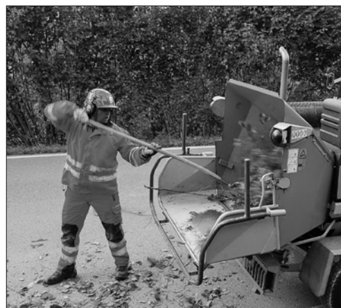
5 Les restes de plantes sont introduits dans les cylindres d'alimentation en les plaçant sur des plus grosses branches et à l'aide d'un long bâton.
