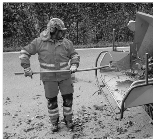
6 Les équipements de protection individuelle (EPI) comprennent un casque, des lunettes de protection, des protecteurs d'ouïe, des chaussures robustes, des vêtements de signalisation à haute visibilité ajustés et des gants à lanière de fermeture.
