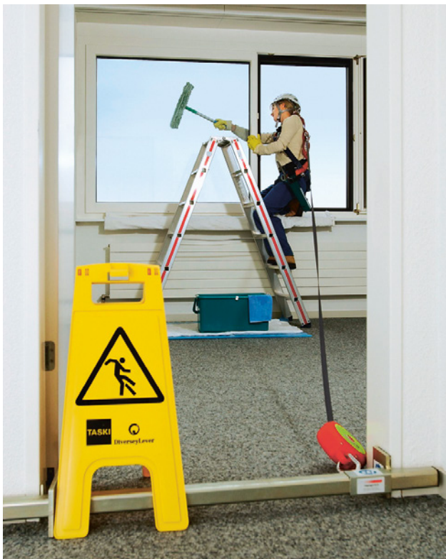
26 Nettoyage des fenêtres. La personne est assurée au moyen d'un antichute à rappel automatique. Le dispositif est fixé, par exemple, à une traverse solidement ancrée dans le châssis de la porte.
