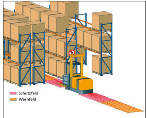
1 Ein mobiles Personenschutzsystem sichert den Bereich vor und hinter dem Stapler mit Scannern, Sensoren gegen Kollisionen mit Personen.
