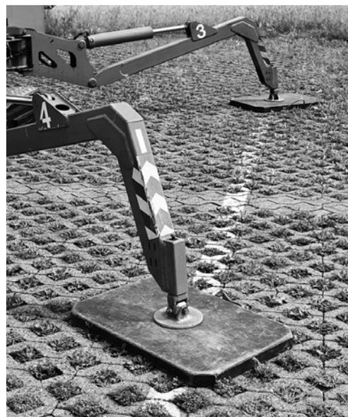
2 Plaques de répartition placées sous les stabilisateurs des PEMP utilisées sur un sol irrégulier.
