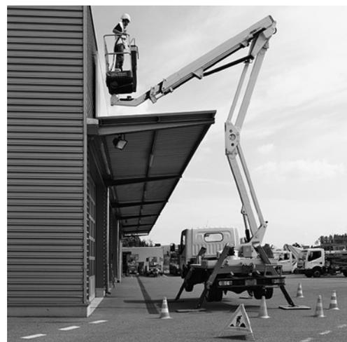
4 Le lieu d'intervention doit être signalé de façon à ce que les passants ne puissent pas pénétrer dans la zone dangereuse de la PEMP.
