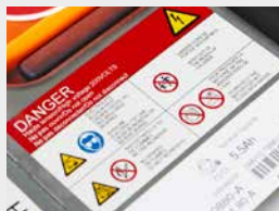
Exemple d'autocollant d'avertissement sur une source d'énergie haute tension
