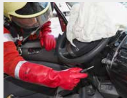
Vérifier l'état de fonctionnement du moteur, éteindre le système (couper le contact), éloigner la clé de contact de l'habitacle.
