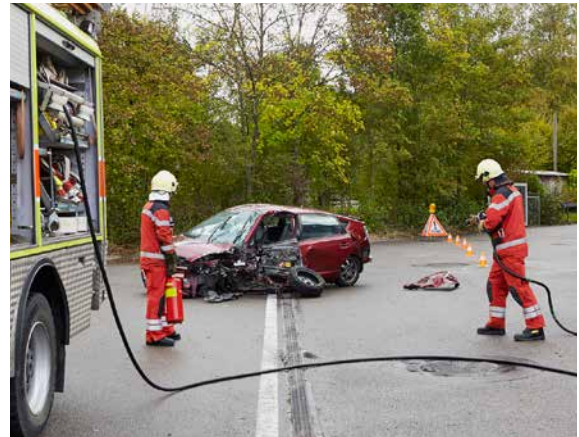
Les véhicules accidentés équipés de systèmes haute tension peuvent présenter différents dangers, par ex. des arcs électriques, des risques d'incendie dus à des fuites de liquides inflammables ou des empoisonnements dus à l'inhalation de substances toxiques.
