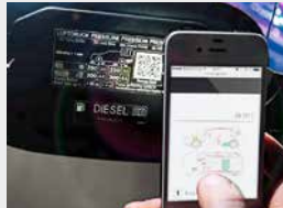
Certains véhicules sont équipés d'un code QR qui permet d'accéder directement aux fiches de secours.
