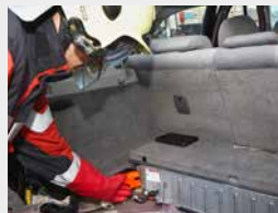
Déclencher (si possible conformément aux instructions du fabricant ou de la fiche de secours), par ex. retirer le sectionneur haute tension de la batterie.
