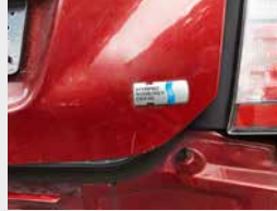
Les connecteurs ou câbles orange, les inscriptions reconnaissables sur le véhicule ainsi que la prise de charge indiquent qu'il s'agit d'un véhicule électrique ou hybride.
