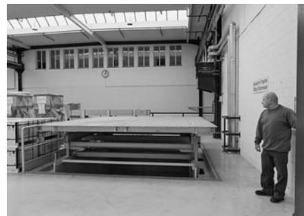
Fig. 7: l'opérateur dispose d'une bonne visibilité sur l'ensemble de la zone de danger autour du toit de l'habitable. La descente du toit de l'habitable est stoppée automatiquement à 120 mm au-dessus du bord de la fosse.
