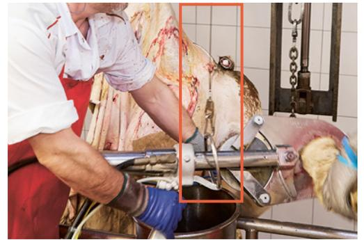
Bild 5: Gewichtsentlastende Aufhängung der Maschine
