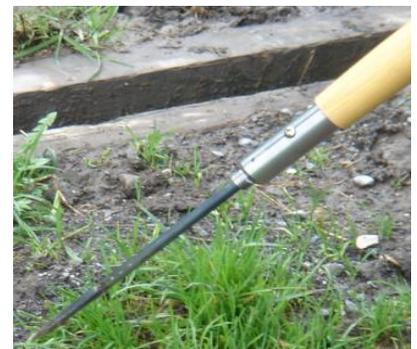
4 Prüfungen die vor dem Besteigen zwingend durchzuführen sind: a. Sichtkontrolle; b. Abklopfen; c. Stossen und d. Untersuchen mit Mastenprüfer.
