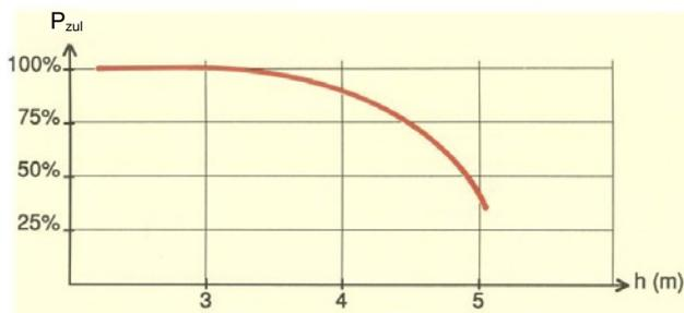
1 Stützenhöhe: Mit zunehmender Auszugslänge h (m) verringert sich die Tragfähigkeit massiv (P<sub>zul</sub> = zulässige Belastung in %). Deckenstützen gemäss SN EN 1065, Klasse D und E, haben eine garantierte Tragkraft über den gesamten Auszugsbereich.
