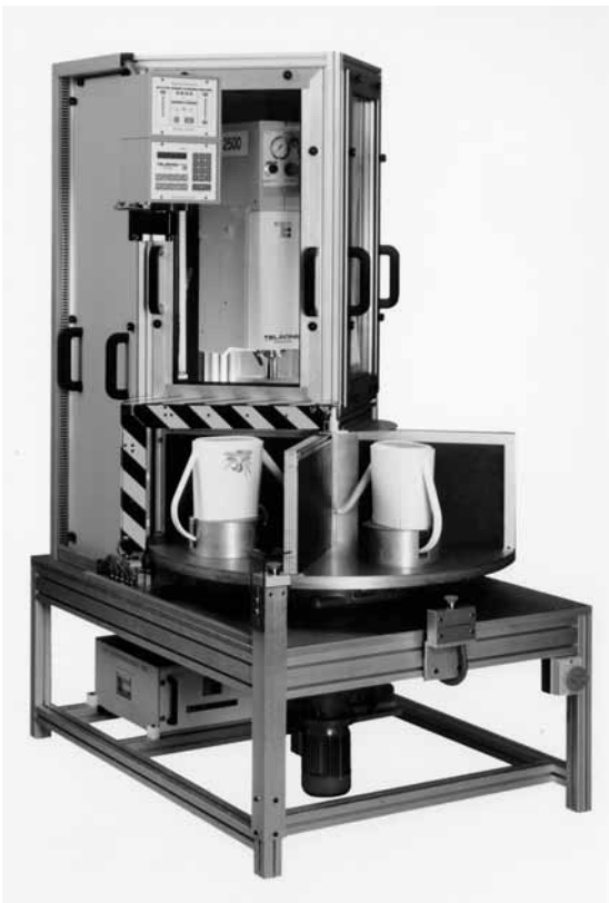
Figure 36 Coffrage sur une soudeuse équipée d'une table rotative
