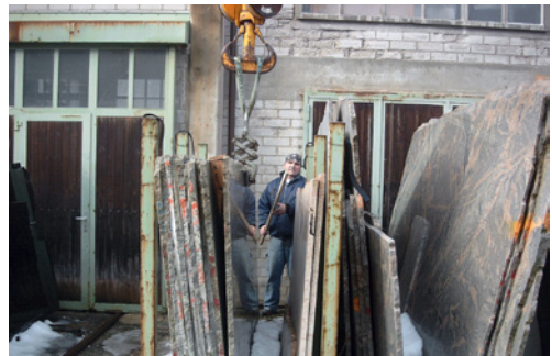
3 Sicheres Auswählen, Anschlagen und Transportieren von Steinplatten. Die Person hält sich ausserhalb des Gefahrenbereichs auf.
