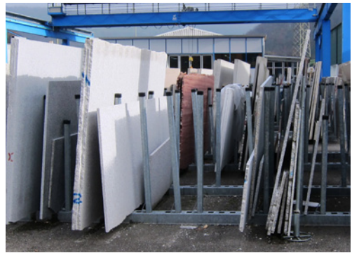
2 Gestell mit Rungen (Stützen) für die sichere Lagerung von Steinplatten
