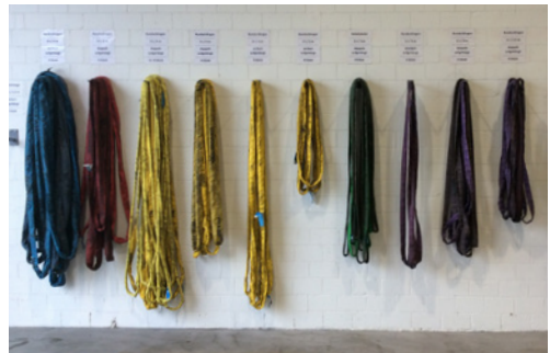
4 Saubere Lagerung der Anschlagmittel
