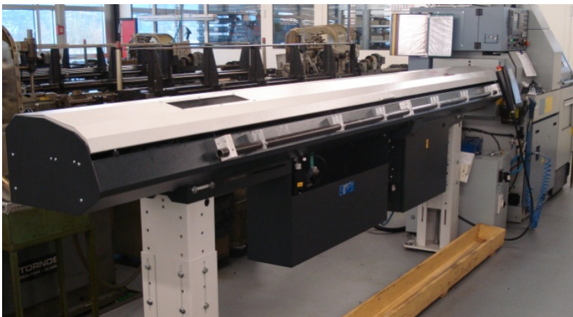
1 Stangenlademagazin mit seitlicher Beladerampe
