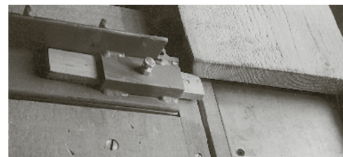
7 Bedienungsseitiger Queranschlag mit nachstellbarem Anschlagholz.
