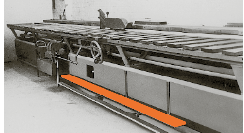
1 Die Verdeckung über der Fusschaltstange verhindert ein unbeabsichtigtes Ingangsetzen des Sägeblatts.
