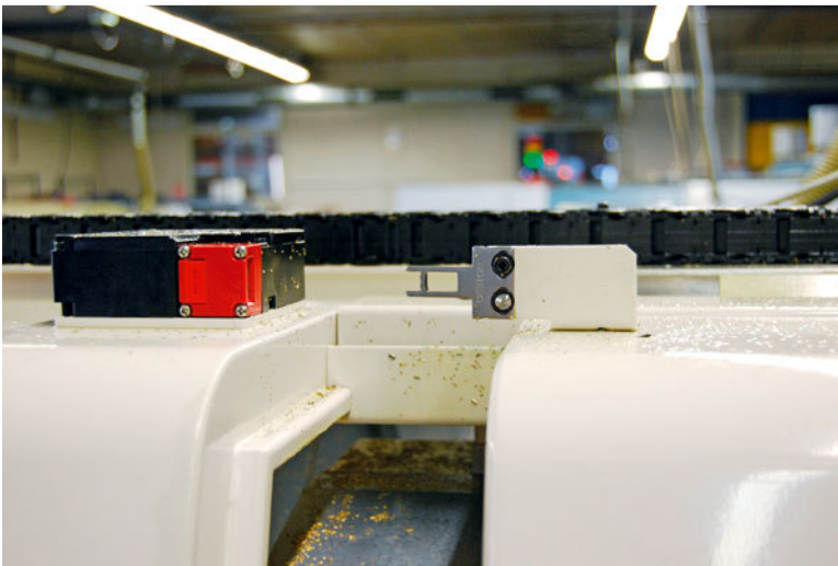
La machine ne peut fonctionner que lorsque la contre-pièce est insérée dans l'interrupteur de surveillance.
