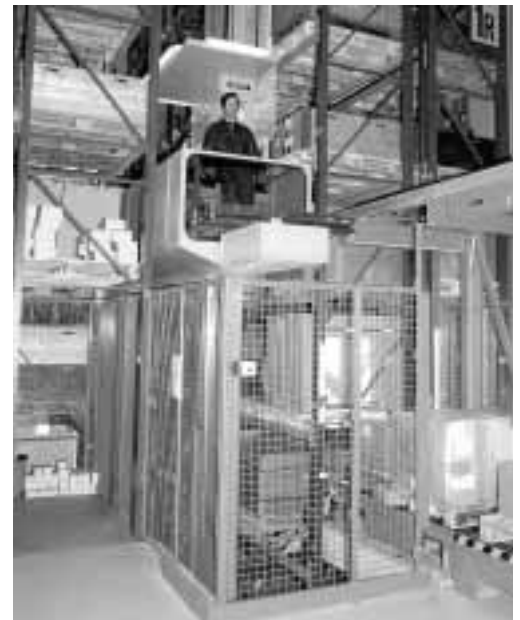
Figura 2: trasloelevatore manuale. L'accesso al mezzo e il punto di carico/scarico del materiale sono protetti.
