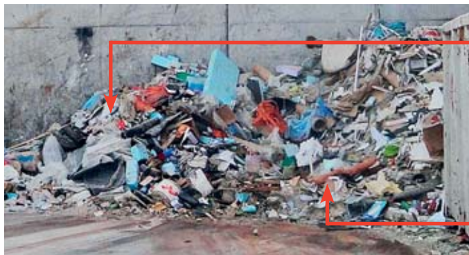
Deckenplatten Akustikdecken und Brandschutzplatten in gemischten Abfällen
