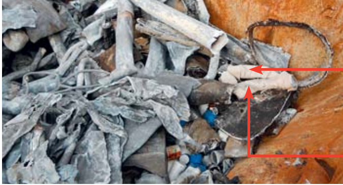
Rohrleitungen mit asbesthaltigem Mörtel
