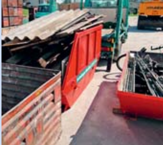
Asbesthaltige Dach- und Fassadenplatten
