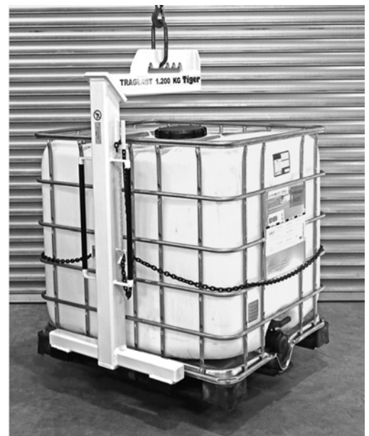
3 Kranwagen mit Sicherungskette für den Einsatz auf Baustellen
