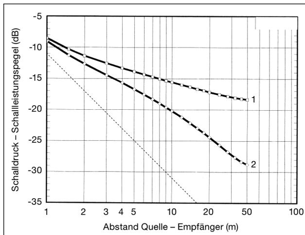
**23** Schallausbreitungskurven SAK für einen geringen Maschinenbelegungsgrad.
