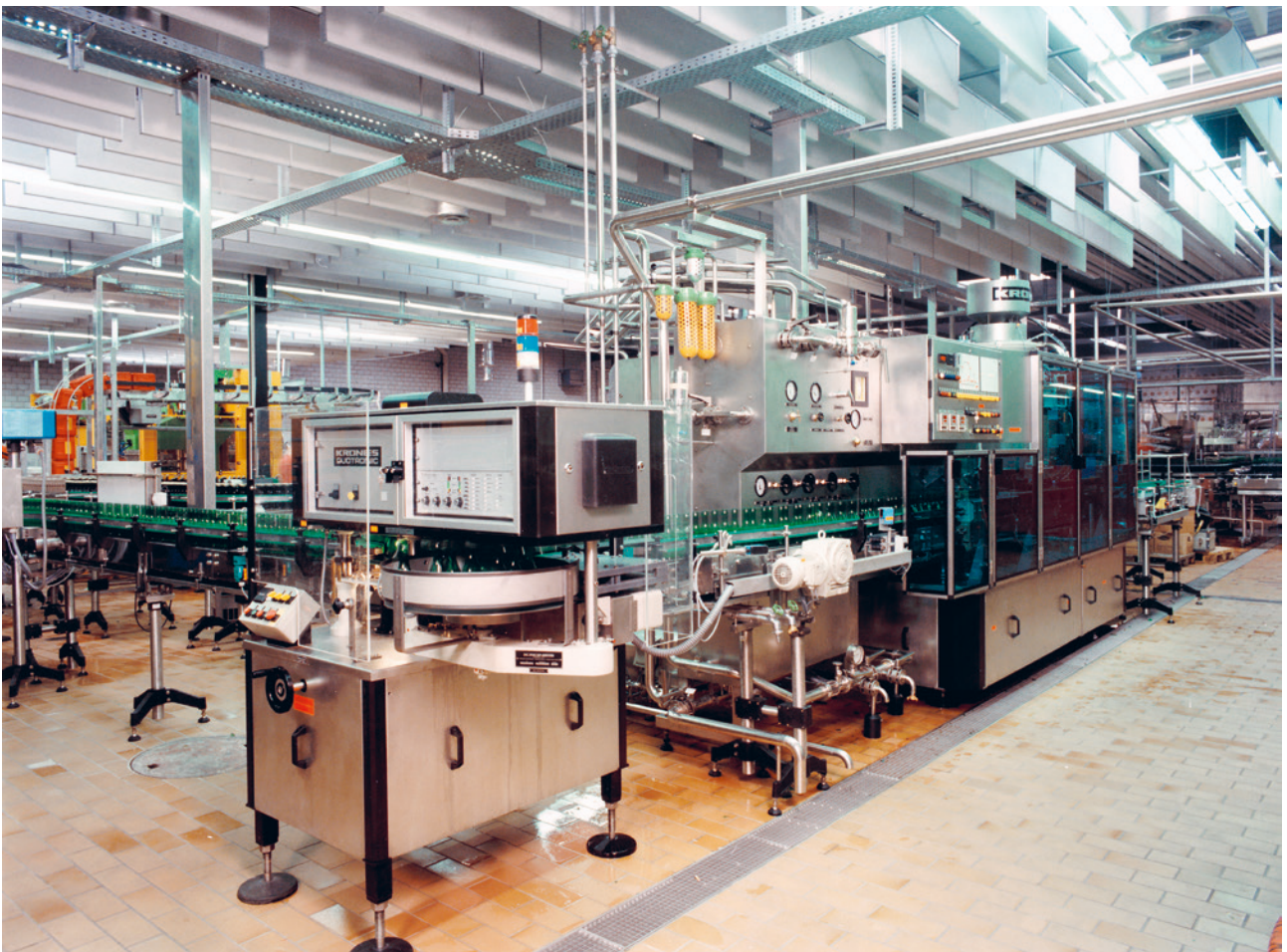
16 Baffeln aus Steinwolle-Akustikplatten in einer Getränkefirma (Abfüllanlagen).
