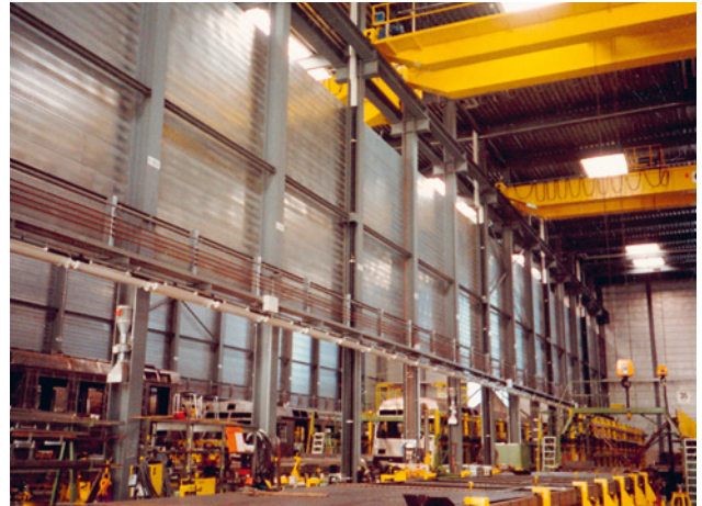
31 Blende zur akustischen Entkoppelung einzelner lärmintensiver Arbeitsbereiche.
