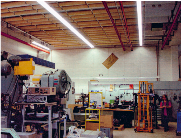
17 Kompaktabsorber in einer Stanzerei.
