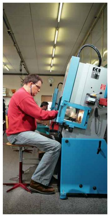
**01** // Die Schutzeinrichtung an der neuen Presse – bewegliche Abschirmung mit Fusspedalbetrieb – gewährleistet eine sichere Arbeitsweise.
