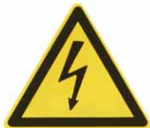
Figura 50: tensione elettrica pericolosa (codice Suva 1729/69)
