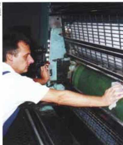
Figura 36: macchina per stampa offset in un'azienda grafica. Il riparo è aperto per l'esercizio particolare. La macchina funziona solo con comando a impulsi e a velocità ridotta (comando a impulsi o a colpi = dispositivo di comando che permette alla macchina di compiere solo una corsa limitata). L'urto contro il listello sensibile (1) provoca l'arresto istantaneo dei cilindri.
