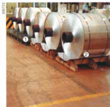
Figura 41: cilindri in uno stabilimento per fogli d'alluminio. I cilindri sono assicurati con cunei (1) e nastri d'acciaio (2) contro una loro caduta dalle palette.
