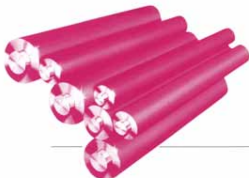
Figura 6: coppia di cilindri con linea d'imbocco non superiore a 120 mm. La velocità periferica del cilindro ( V_1 ) è maggiore di quella del cilindro ( V_2 ). Esiste il pericolo di trascinamento di dita, mani e braccia.
