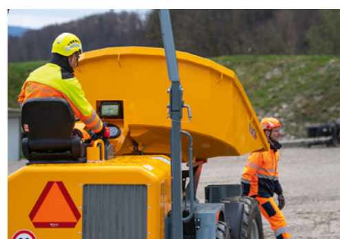
9 Person im Gefahrenbereich – mit einer technischen Massnahme (Kamera) wird dies rechtzeitig erkannt
