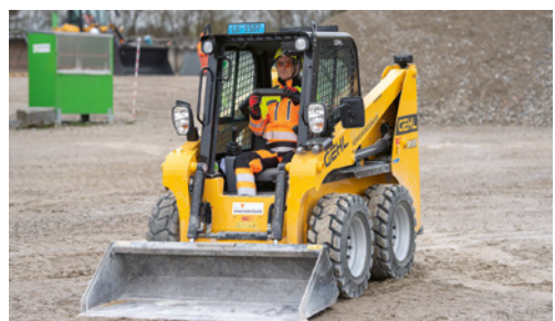
5 Kleinbagger mit Sicherheitsgurt und Überrollschutz (ROPS/TOPS)
