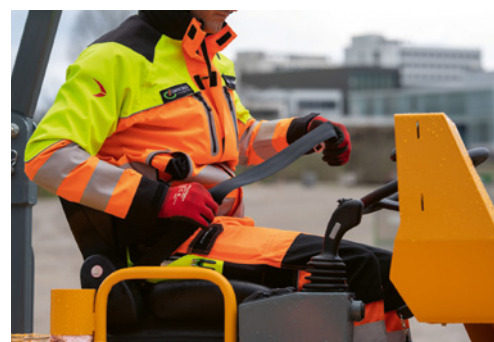
8 Baumaschinenführer benutzen immer den Sicherheitsgurt (inkl. Überrollschutz)
