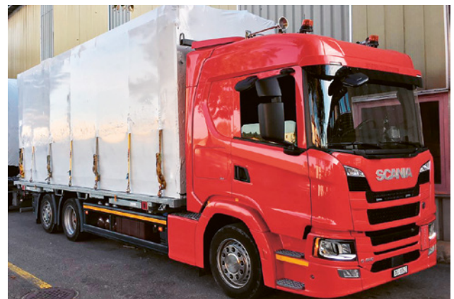
2 Sicherung der Wechselpritsche mit dem Twist-Lock-System. Witterungs- und Transportschutz mit weisser Folie.
