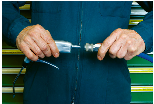
6 Utilizzare raccordi di sicurezza.
