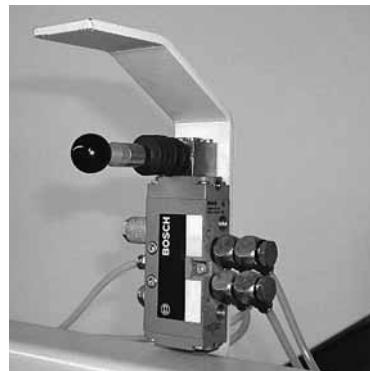
Figura 1: comando ad azione mantenuta di tipo pneumatico. Il pressore si abbassa quando la leva è premuta verso il basso. Rilasciando la leva si interrompe la discesa del pressore.
