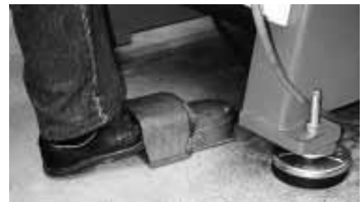
Figure 2: la commande à pied (pédale) doit être équipée d'une cape de protection.
