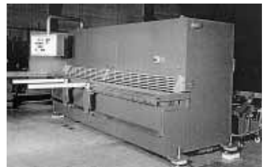
Figure 4: afin d'éviter les blessures aux doigts et aux mains, il faut que la ligne de coupe soit sécurisée sur toute la longueur de la lame au moyen d'un dispositif de protection robuste.
