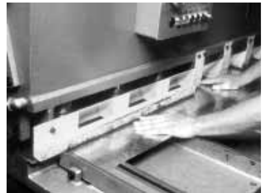
Figure 3: le dispositif de protection doit empêcher la main de l'opérateur de s'engager sous le dispositif de bridage (presseurs).
