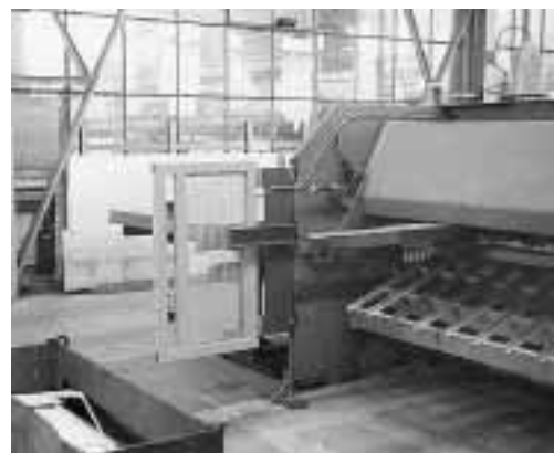
Figure 6: exemples de dispositifs de sécurité pour l'arrière de la machine: barrières photoélectriques, grilles de protection, élément d'éloignement tel qu'une tôle inclinée ou une table fixe ou mobile de récupération des tôles découpées.
