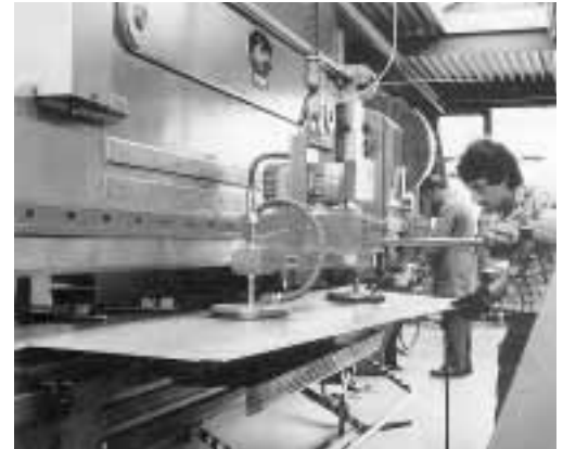
Figure 1: accessoire de levage à ventouses pour les tôles.
