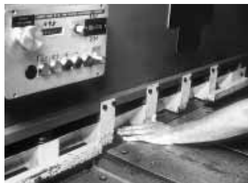
Figure 5: dispositif de sécurité avec dégagement offrant une bonne visibilité sur la ligne de coupe et permettant la coupe de tôles de petites dimensions.
