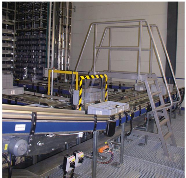
6 Passerelle sécurisée latéralement par deux garde-corps. Cela empêche efficacement toute chute d'objets ou de personnes sur le convoyeur automatique. Les marches d'accès sont sécurisées par une main courante des deux côtés.
