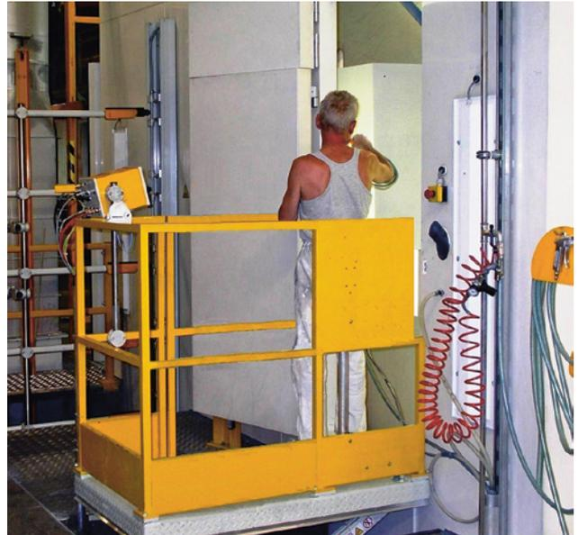
5 Cette plateforme élévatrice a une hauteur maximale de levage de 1 m. Le garde-corps protège l'opérateur des chutes (p. ex. en cas de faux pas en arrière) quelle que soit la hauteur du pont. Il arrive que les conditions de travail rendent obligatoire l'installation d'un garde-corps à une hauteur de chute inférieure à 500 mm.
