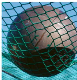
5 Sfera di 100 kg utilizzata per la prova (altezza di caduta 2,5 m)
