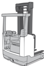
R2 Chariots élévateurs à siège transversal, à haute levée et quadridirectionnels
