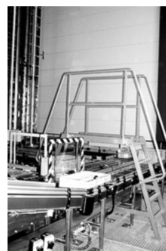
6 Passerelle au-dessus d'un convoyeur à rouleaux.
