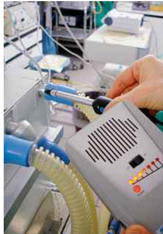
Anästhesiegas – Leckagemessung im Operationsaal
