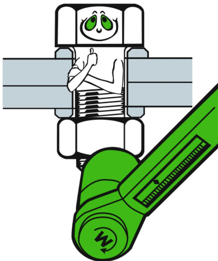
Serrez toujours les assemblages par boulons haute résistance avec une clé dynamométrique. Vous trouverez les indications concernant le couple approprié dans les instructions de service.
