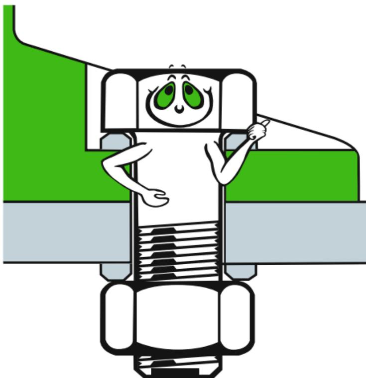
Il faut que l'assise de la tête de boulon et de l'écrou soit à angle droit par rapport à l'axe du boulon.
