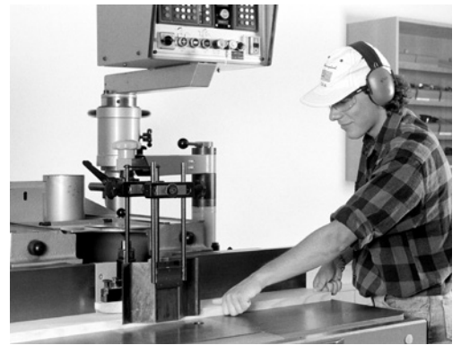
3 Handvorschub (MAN): Als Handvorschub gilt, wenn das Werkstück von Hand gehalten und geführt wird.
