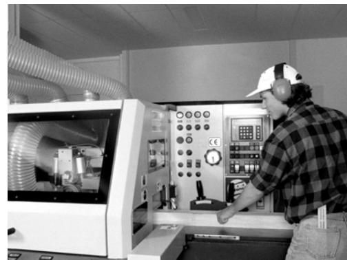
6 Mechanischer Vorschub (MEC): Beim mechanischen Vorschub wird das Werkstück oder das Werkzeug kraftbetrieben geführt und das Werkstück ist dabei gespannt (z.B. Vierseitenhobelmaschine, Doppelendprofiler, CNC-Bearbeitungszentrum).
