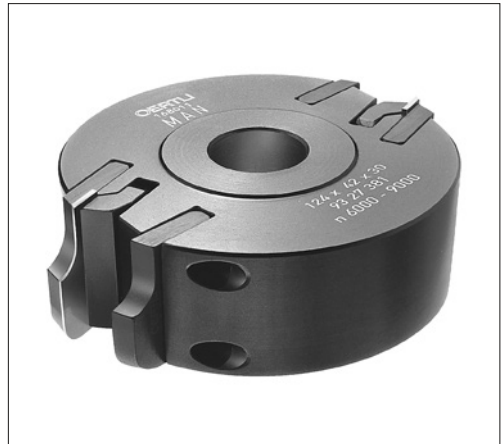
1 Korrekt beschriftetes Werkzeug für den Handvorschub.
