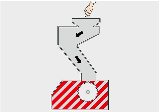
4 Limitation des mouvements par le biais d'une déviation à l'intérieur de la trémie d'alimentation
