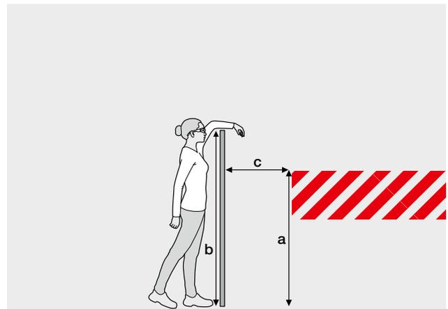
Distances de sécurité empêchant un accès par-dessus des structures de protection (p.ex. barrières)
