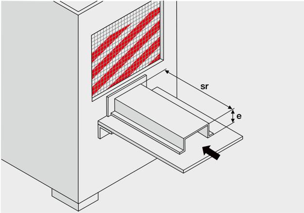
3 Limitation des mouvements par un protecteur-tunnel
