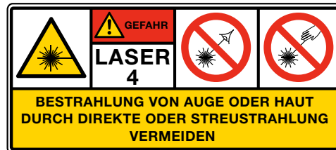
1 Klassifizierung, Laserwarnzeichen «Laser Klasse 4» und Laserhinweiszeichen nach Norm SN EN 60825-1
