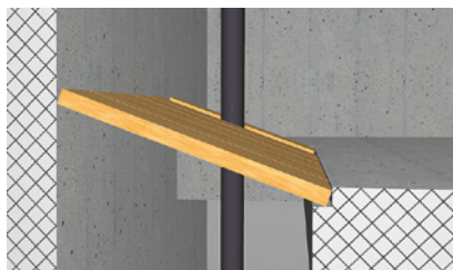
2 Piccola apertura nei pressi di una parete con tavole incuneate
