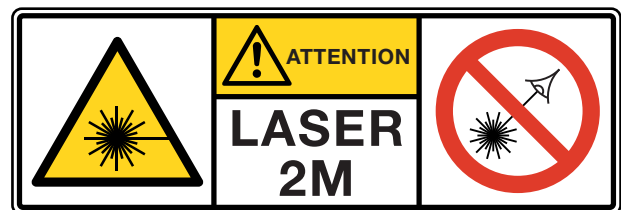
Fig. 10: étiquetage de la classe laser 2M. Il est également possible d'utiliser le même étiquetage qu'au chapitre 6.2.
