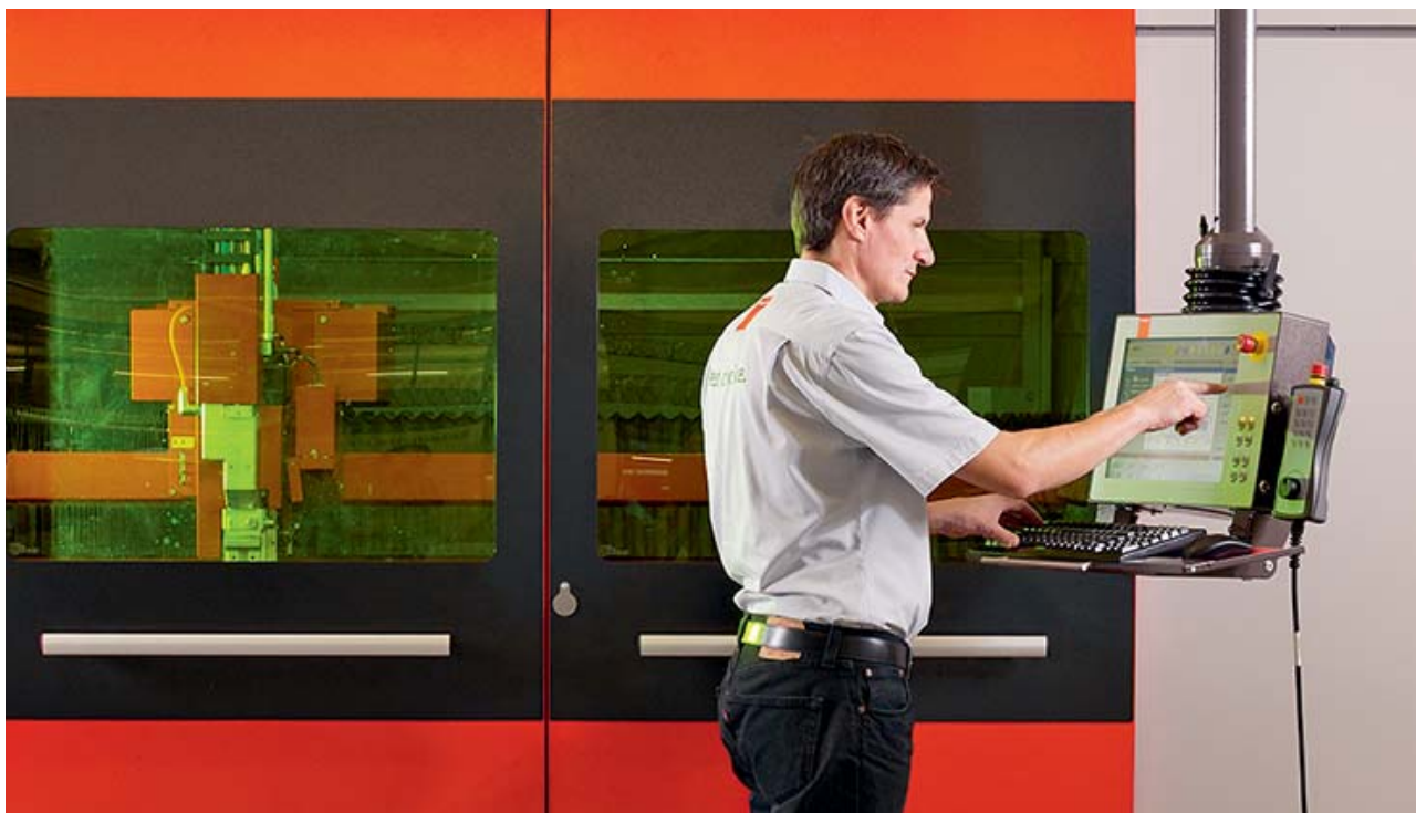
Fig. 15: un appareil à laser installé dans des ateliers de production doit être équipé d'un capot de protection à blindage intégral.
