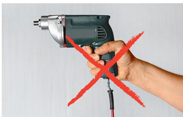
4 Câbles et outils défectueux: danger d'accident!
