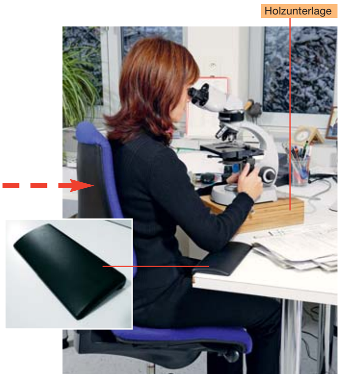
Bild 6 Die Holzunterlage ermöglicht eine korrekte Körperhaltung. Eine Arm-oder Ellbogenauflage «entschärft» kantige Tischplatten.
