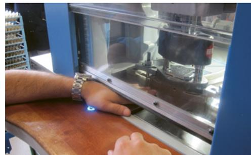
5 Bewegliche Schutzscheibe mit Kontaktleiste. Sie schützt Hände und Finger vor der Gefahr, zerquetscht zu werden.
