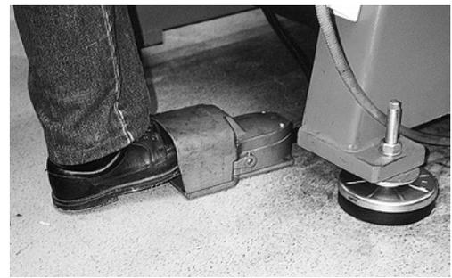
2 Der Fusschalter (Pedal) muss mit einer Schutzhaube ausgestattet sein.
