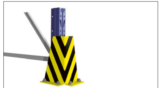
1 Anfahrerschutz an den Ecken der Regale (Mindesthöhe 400 mm; am Boden festgeschraubt und nicht mit dem Regal verbunden).
