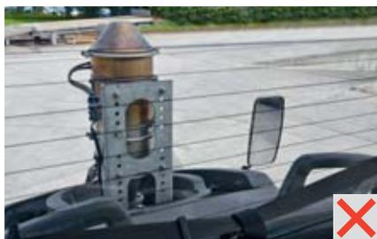
**Foto 4** Angolo morto dovuto alla sovrastruttura del filtro antiparticolato.
