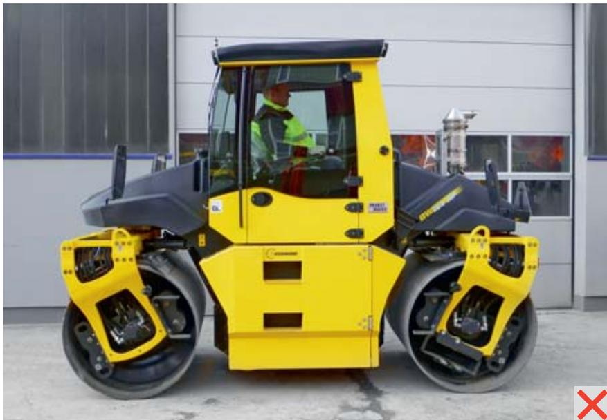
**Foto 3** Rullo compressore con sedile girevole. La presenza del filtro antiparticolato sulla parte posteriore del veicolo limita la visuale del conducente durante la retromarcia.
