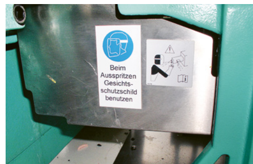
8 Beim Hantieren an der heissen Spritzeinheit sind zum Schutz vor herausspritzendem heissen Kunststoff Gesichtsschutzschild, Handschuhe und geschlossene Arbeitskleider zu tragen.
