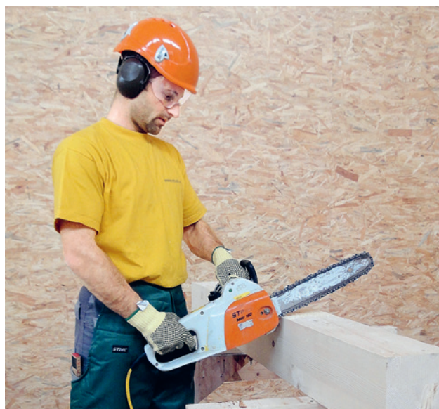
1 Für die Arbeit entsprechende Schutzausrüstung tragen
