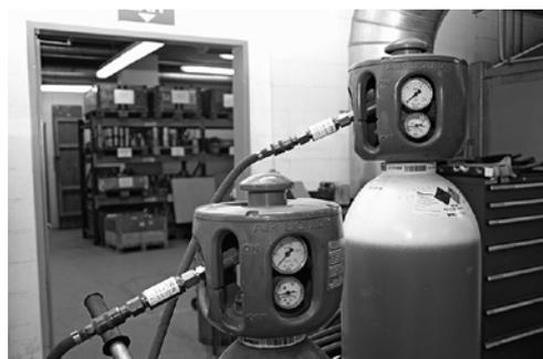
6 Bouteilles de gaz avec chapeau de protection, régulateur de pression intégré, affichage du niveau de gaz et dispositif de sécurité.
