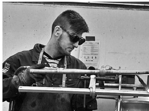
5 Opération de chauffage à la flamme. Soudeur avec lunettes de protection (échelon de protection 4 à 7 selon EN 169) et tampons auriculaires.
